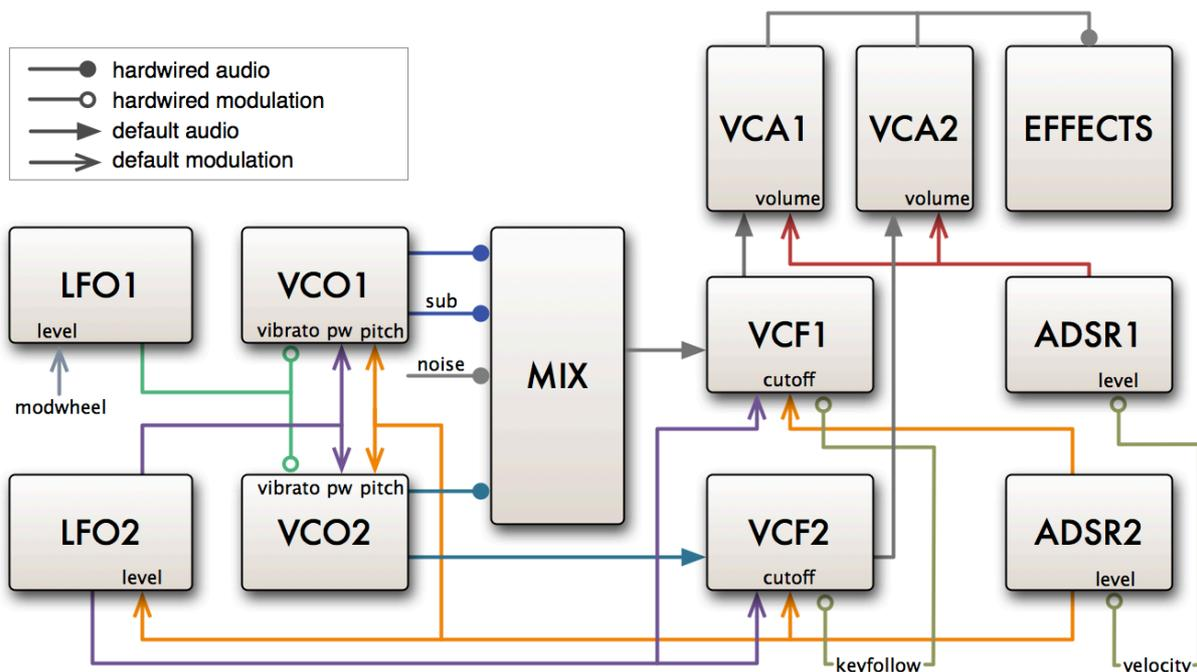
VCO1 und Suboszillator, VCO2 und weißes Rauschen werden gemischt und zu VCF1 geleitet, das wiederum zu VCA1 geleitet wird (rechts vom Oszilloskop, nicht beschriftet). VCO2 wird ebenfalls über VCF2 zu VCA2 geleitet.
